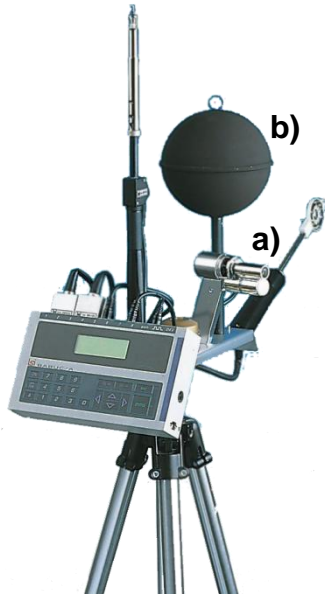
Figura 8 - Estação microclimática BABUC-A. a)psicrômetro; b)termômetro de globo
