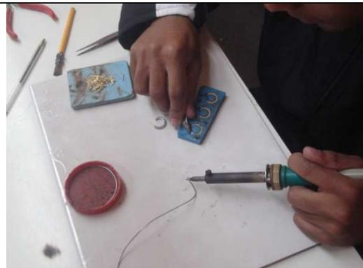
Figura 03: Solda a frio, com utilização de soldador tipo caneta.
