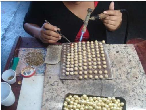
Figura 02: Solda a quente, com utilização de maçarico.
