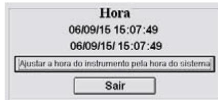
Clique em “Ajustar a hora do instrumento pela hora do sistema” para ajustar o horário do instrumento pelo horário do sistema do computador.
