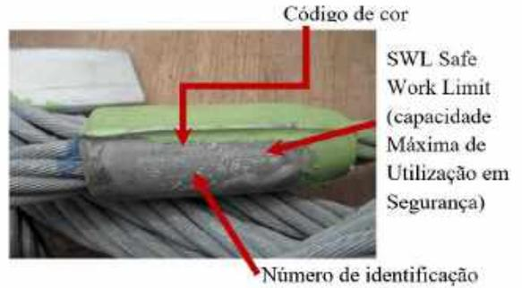
Figura 8 – Inspeção na presilha
