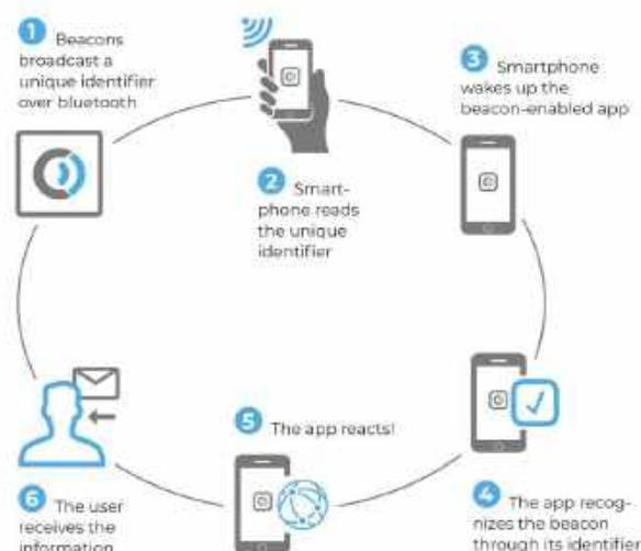
Figura 1 - Funcionamento do Beacon com o Smartphone
