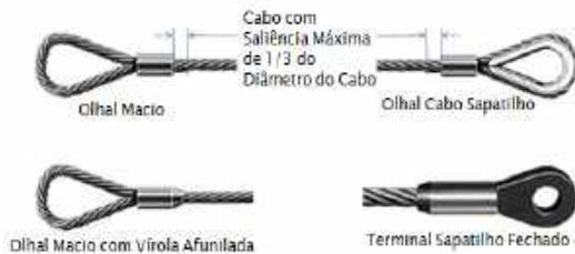
Figura 6 – Tipos de olhais e presilhas em cabos de aço
