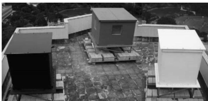
Figura 5 – Células-testes empregadas no estudo da cor e massa térmica da envoltória
