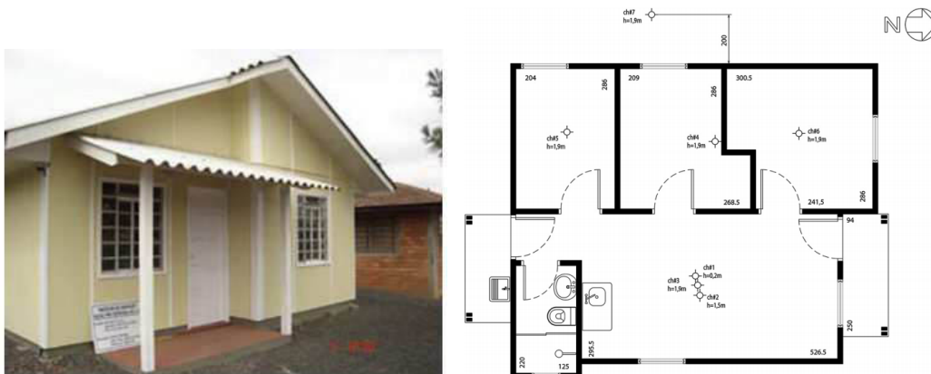
Figura 9 – Protótipo com vedações em painéis de madeira
