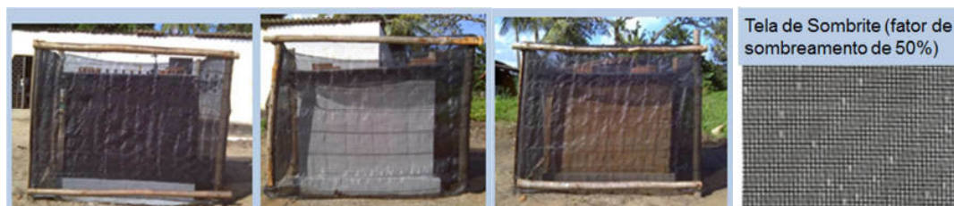
Figura 13 – Células-teste com a simulação do efeito de sombreamento de 50% na envoltória.
