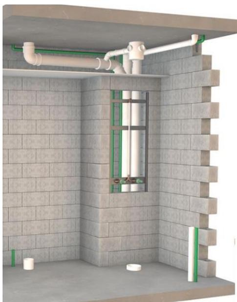
**Figura 28** - Concepção de um sistema hidrossanitário em alvenaria estrutural.
