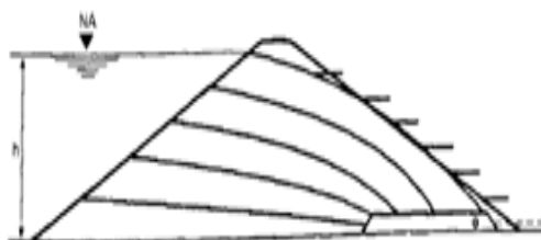
Figura 5: Esquema de linha de fluxo em uma barragem de terra.
