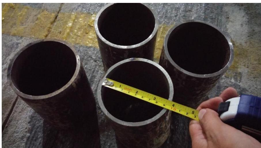
*Figura 3 - Anéis utilizados na coleta de amostras indeformadas.*
