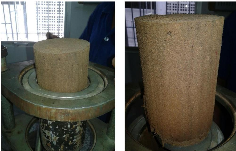
Figura 7 – Processo de retirada da amostra do anel de confinamento, com emprego de macaco hidráulico (LAPAV).
