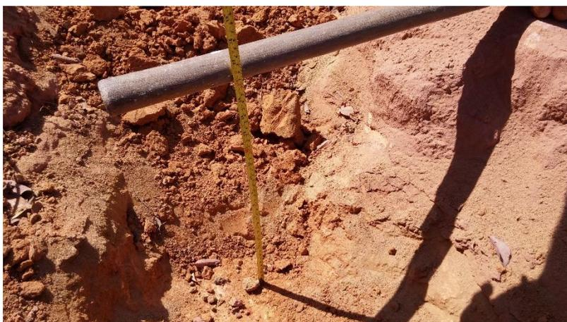
Figura 4 - Rebaixamento realizado na cabeceira do acesso, em tentativa de retirada de amostra indeformada.
