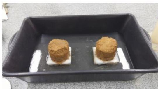
Com o nível d'água na base da amostra
