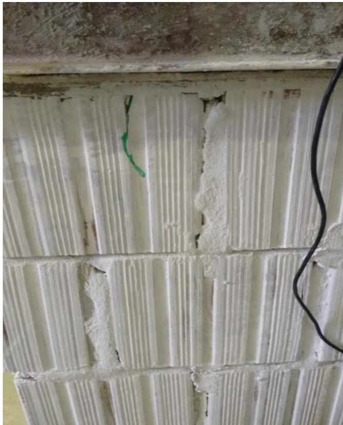
Figura 13: Primeira fissura observada no corpo de prova 01.
