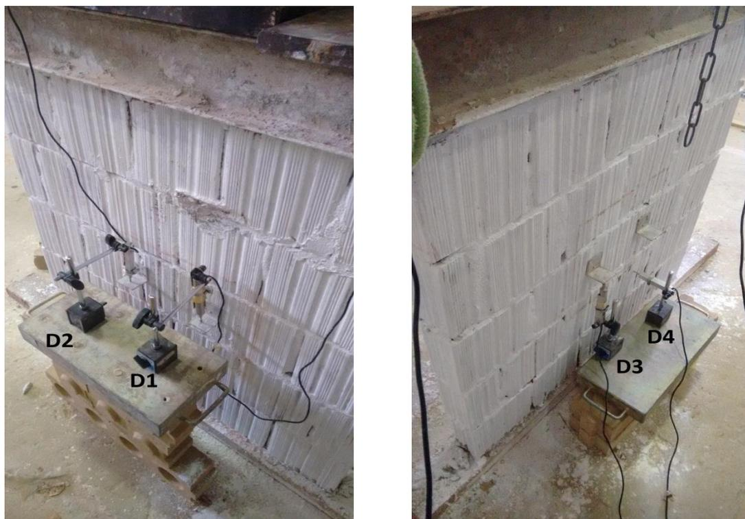
Figura 5: Posicionamento dos defletômetros no painel de alvenaria.
