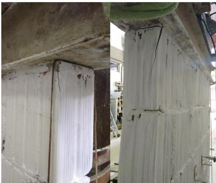
Figura 22: Primeiras fissuras no corpo de prova 03.
