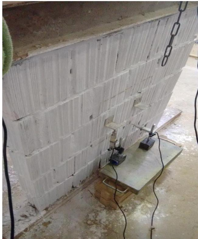
Figura 21: Corpo de prova 03 pronto para o ensaio.
