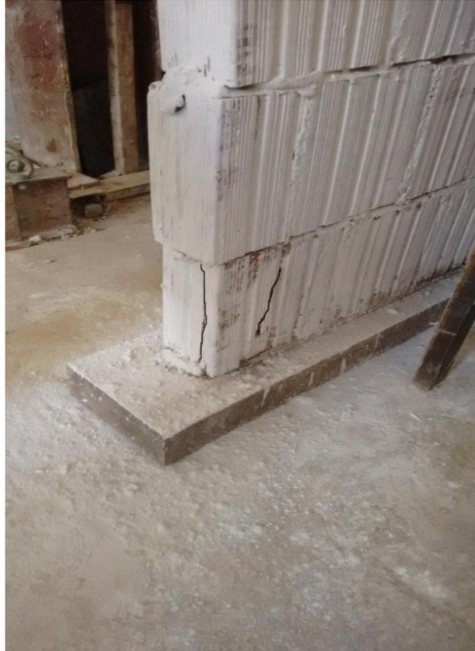
Figura 18: Primeiras fissuras observadas no corpo de prova 02.
