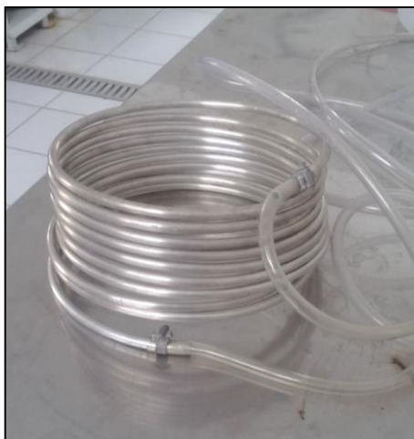
Figura 5 – Chiller de alumínio, 7,5 m de comprimento
