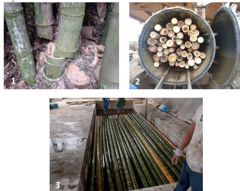
**Figura 06:** Cura no bambuzal (1), Autoclave (2), Imersão (3). Fontes, respectivamente: cbhmacae.eco.br; www.bambu.wiki.br; bambusa.es.
