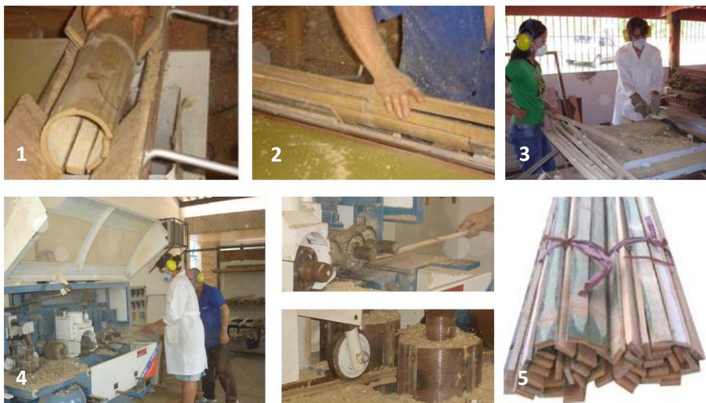
**Figura 09:** Processo de laminação do bambu. Fonte: MOIZES, 2007.
