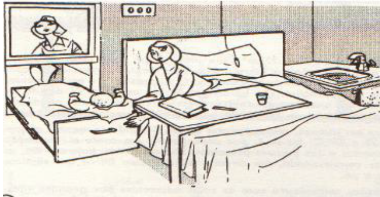
Figura 01: Quarto de pós parto com berço de correr para visita do bebê apresentado no livro A Arte de Projetar em Arquitetura.
