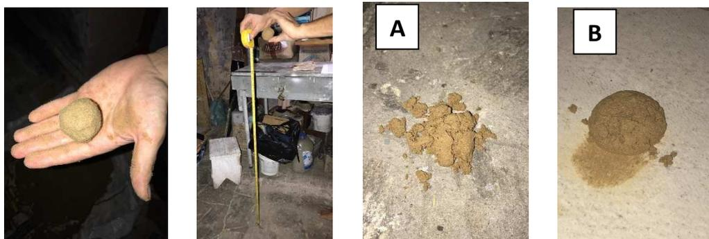
Legenda: Figura 1: "Bolinha" de solo, cimento e água para teste de umidade. Figura 2: "Bolinha" da mistura sendo lançada a 1 metro de altura. Figura 3: Resultado "A" umidade inadequada. Figura 4: Resultado "B" resultado adequado. Fonte: Autores
