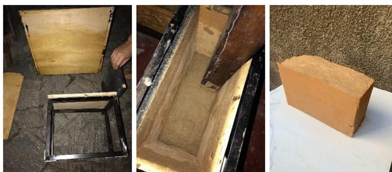
Legenda: Figura 1: Montagem da estrutura das fôrmas. Figura 2: Processo de compactação. Figura 3: Resultado da prototipagem. Fonte: Autores
