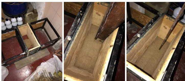
Legenda: Figura 1 e 2: Processo de compactação da mistura. Figura 3: Teste da barra de ferro.
